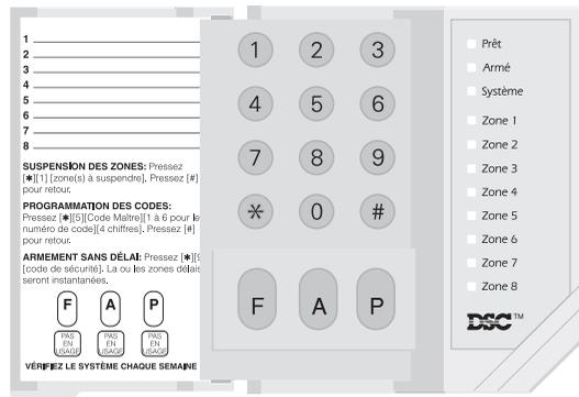
**Programmation** Le témoin lumineux «Système» clignotera quand vous programmez les codes d'accès, ou effectuez d'autres fonctions de programmation. Si quelqu'un programme sur à un autre clavier, le témoin lumineux Système s'allumera pour indiquer que le système est occupé.
